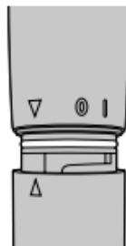
4 乾電池ホルダーを本体に戻し、設定マークが「I」の位置に合うまで、右へ回します。
