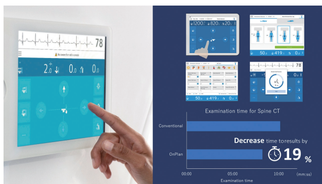
Fig.4 OnPlan Touch Screen 寝台の操作だけでなく、患者登録や患者氏名の確認、撮影方向の指定、Examカードの選択などができる。検査中に必要な息止めのデモンストレーションは、患者とのコミュニケーションや検査への不安軽減に役立つ。
