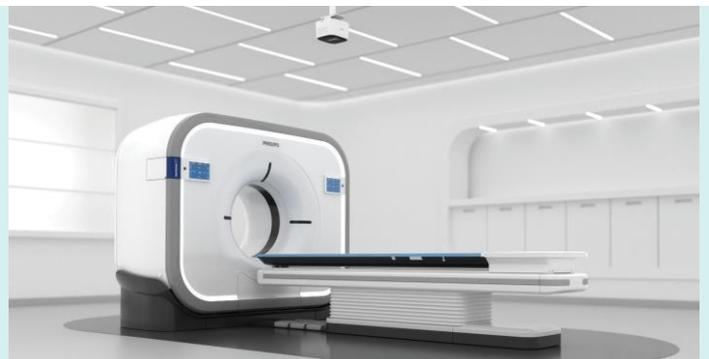
Figure 1 Precise Positionに搭載されている天井に設置されたAI対応カメラ
