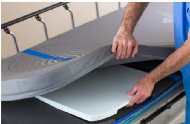
図3a. テーブルトップ型フィールドジェネレータをベッドの上に設置
