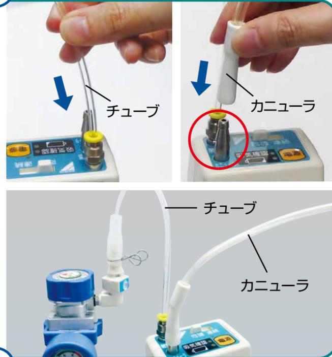
3 ライトテックDS22の酸素供給モードを「同調」にし、電源スイッチを“ピッ”と音がするまで押し下さい。
