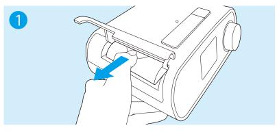
機器の電源がオフになっていることを確認してください。アクセサリードアを開き、モデム外装のくぼみに指をそえて取り外します。
